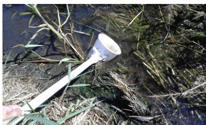
Figura 10: raccolta larvale mediante l'uso di apposito "pescalarve".
